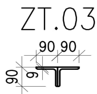
Obr.: průřez ZT.03 (koncové příčné diagonální ztužení HN)
